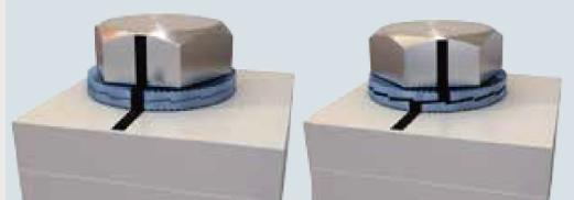
当我们松开一个防松垫圈的锁紧系统时候，检查两个对齿面的滑动情况
