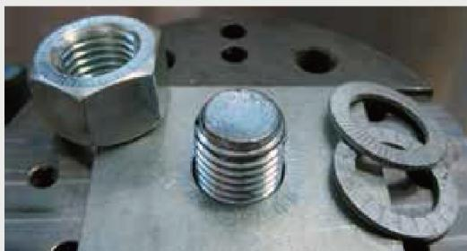
松开后，螺栓头上和母材的接触面上都必须有印迹
