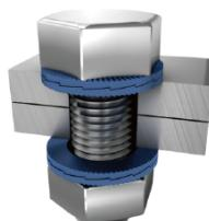
2、首先保持螺母一侧并用10% 所需扭矩（或工具可显示的最低扭矩）拧紧螺栓一侧，以关闭凸轮。然后保持螺栓一侧并以对应于所需夹紧载荷的扭矩拧紧螺母一侧
